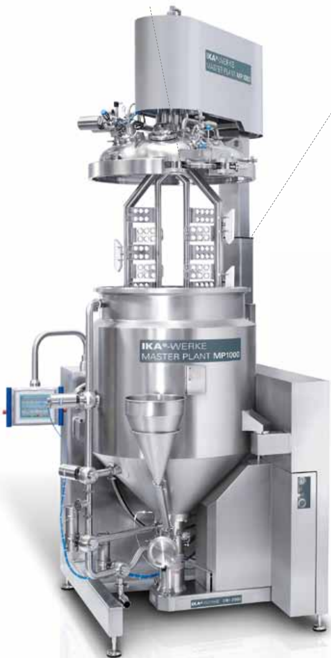
Master Plant MP 1000 z podniesionym do połowy mieszadłem przeciwbieżnym
